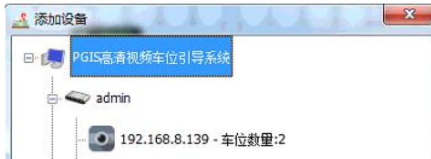
然后再右键点击 IP 段“添加设备到地图”。此时，地图上会出现此段 IP 的所有摄像机探测器（蓝点），蓝点从左到右，IP 由小到大，左键点击每一个点，在地图左下的地方都能看到此摄像机的 IP
