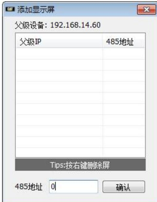
将所连接的屏的地址写进去，点确认，在地图上把引导屏挪动到实际安装位置上，引导屏添加完成，再次重启软件。
