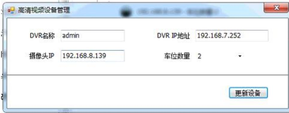
输入车位摄像机的 IP、车位数量，车位数量表示这 IP 摄像机应检测的车位数。
